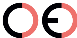
Faux marquage CE (trop éloigné)
